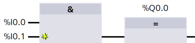
การต่อใช้งานหน้าสัมผัสแบบ AND เกตด้วย Function block diagram
